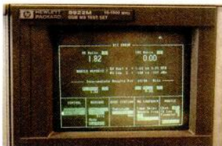
Nos tests comprennent aussi, en plus de la mesure de la sensibilité, la mesure de la qualité de l'appel et de la qualité de la transmission.
