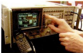
Un test de sensibilité pour mesurer la capacité d'un téléphone à capter un signal très faible du réseau et à le restituer avec une bonne qualité d'écoute.
