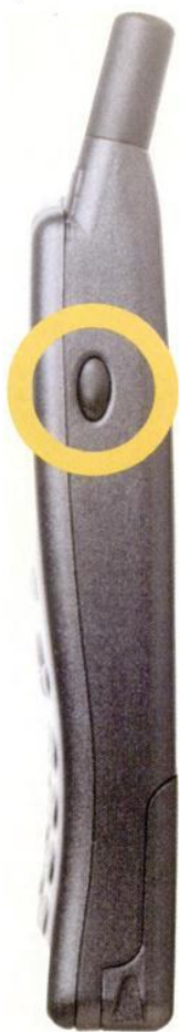
▲ Le vibreur s'active par simple pression sur une touche située sur le côté gauche de l'appareil
