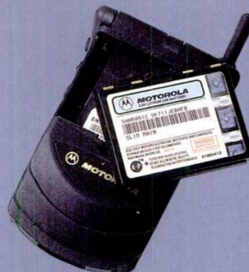
▲ La batterie du StarTAC 130 se place sur le dessus de l'appareil, comme sur les précédents modèles.
