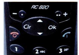
Sagem a choisi de regrouper les quatre commandes principales en une touche multifonction, à la différence de la série 7.
