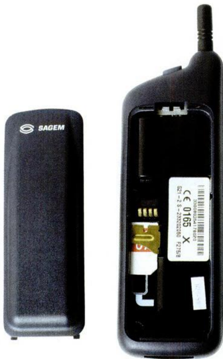
La batterie NiMH, légèrement bombée, prend quasiment toute la hauteur de l'appareil.
