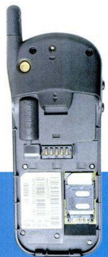
▲ Comme certains autres téléphones de la gamme One Touch, le Max accepte une batterie classique NiMH...
