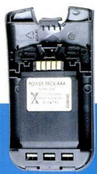
▲ Comme certains autres téléphones de la gamme One Touch, le Max accepte une batterie classique NiMH...
