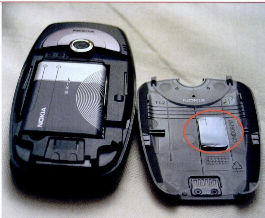
La batterie BL-6C prend place sous le capot du Nokia 6600. Vous pouvez ôter l'épais scotch (entouré de rouge) pour faciliter sa fermeture.
