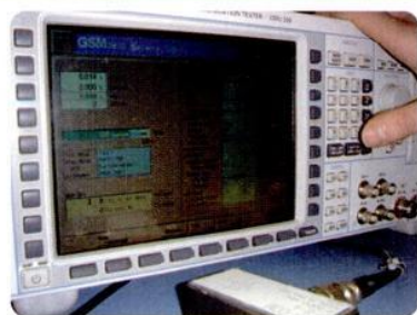
4 Les instruments de mesure interprètent le signal renvoyé par le mobile et calculent le taux d'erreur (BER) par rapport au signal natif envoyé par le simulateur.
