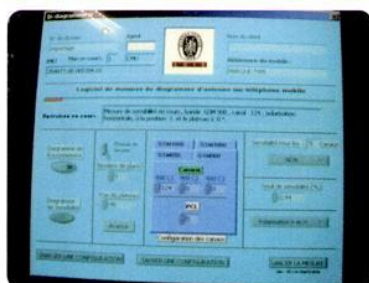
5 Petit à petit, la puissance d'émission est réduite jusqu'à ce que le taux d'erreur maximum de 2,4 % soit atteint. La puissance à ce stade correspond à la sensibilité de l'appareil.
