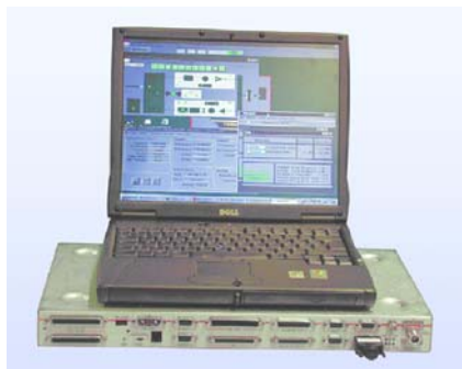
Coffret principal IDU et poste d'exploitation
