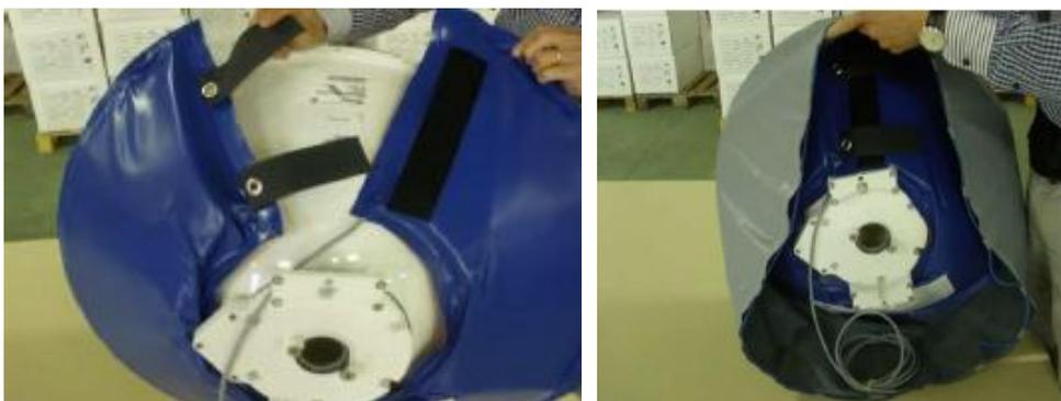
Figure 12 : Installation couverture chauffante sur antenne
