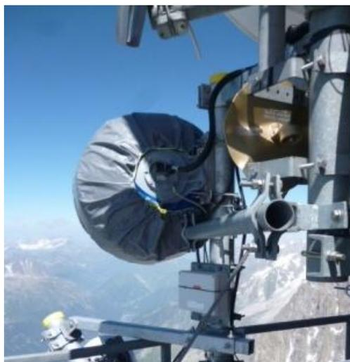
Figure 14 : Couverture chauffante installée sur site 30683 (l'Aiguille du midi)
