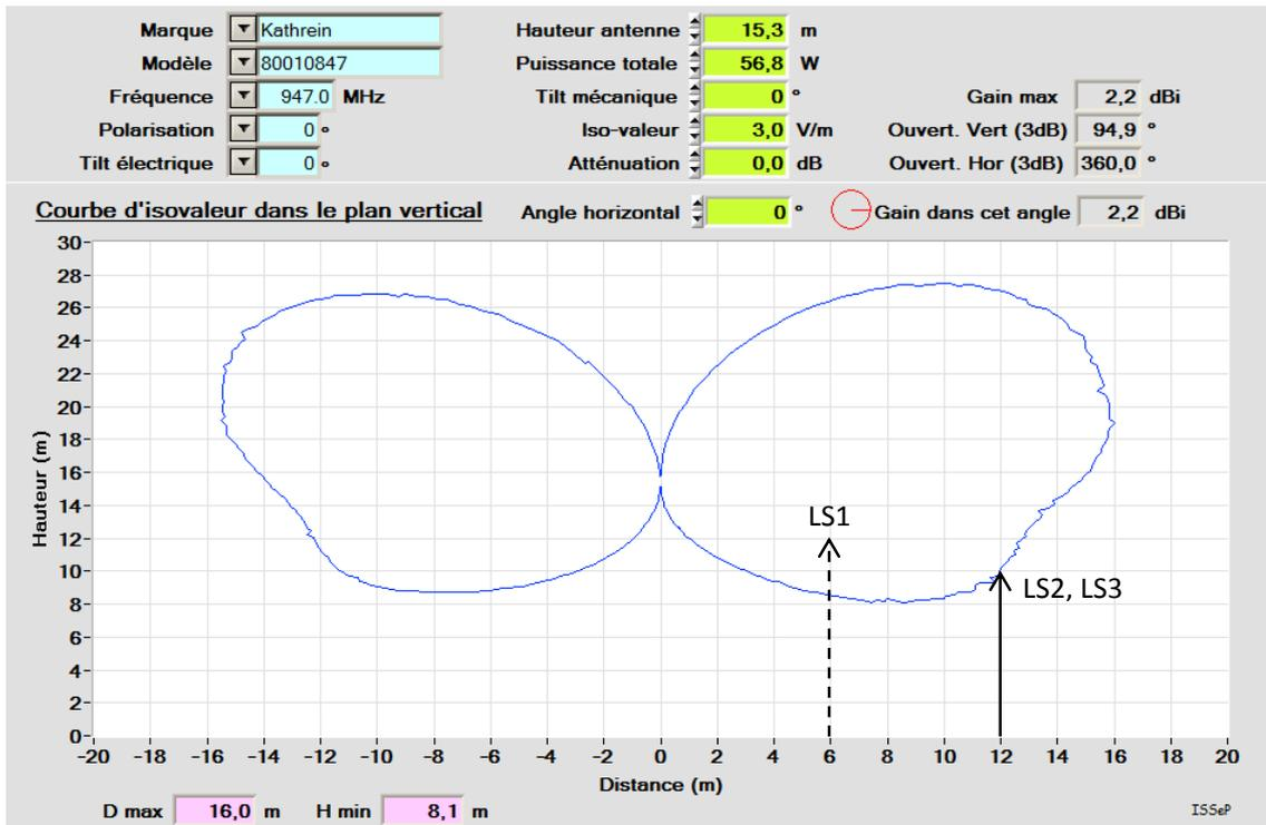
ANTENNE N° 1 – GSM – OMNI (Avec atténuation de 5dB)
