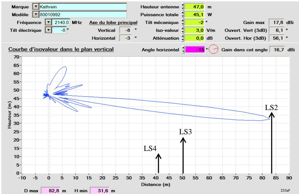
ANTENNE N° 5 – Bande de fréquence 2100 – 160°
