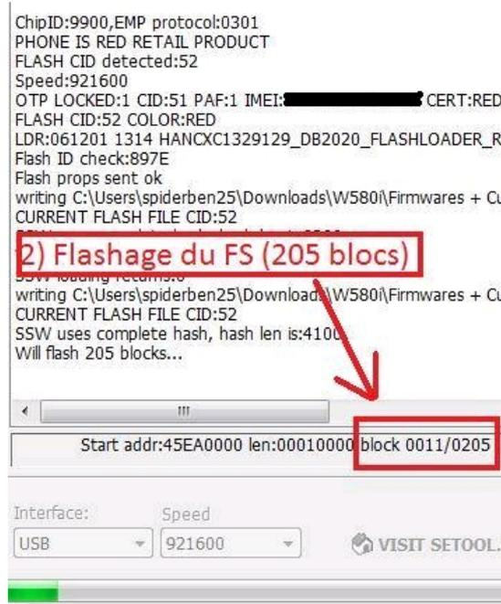
Le flashage est terminé lorsque "Elapsed:(temps du flashage)" apparaît dans la partie gauche de la fenêtre. Maintenant, dans la partie droite de SeTool, cliquez sur Clear pour supprimer le MAIN et le FS de la liste puis ajoutez le fichier de customisation (nommé hb1-
